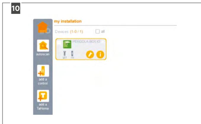
Una vez de vuelta en el menú principal, tendrá un claro resumen de todos los dispositivos encontrados. Los iconos que aparecen junto a cada dispositivo muestran si éste ya ha sido configurado (SET) y si ya hay un emisor manual conectado a él (1W, 2W).
