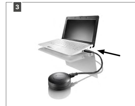
Conecte la herramienta de instalación Set&Go a su PC con Windows mediante el cable USB suministrado.
