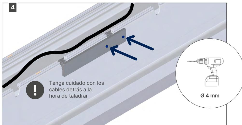
**Observación:** empuje la pieza calibradora hacia abajo a la hora de taladrar.
