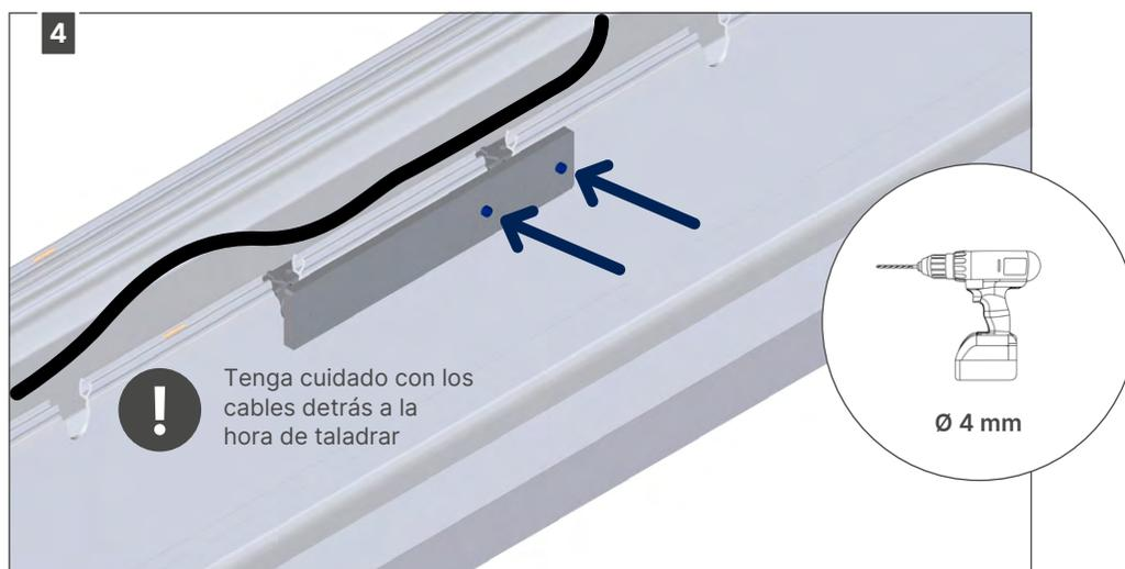
**Observación:** empuje la pieza calibradora hacia abajo a la hora de taladrar.
