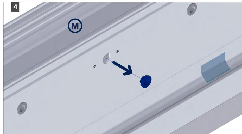
Observación: empuje la pieza calibradora hacia abajo a la hora de taladrar.
